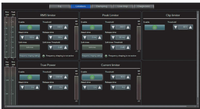
Limiterstruktur der 1204 mit fünf Instanzen (Abb. 10)
