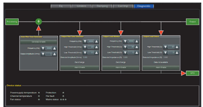
Diagnosestruktur der 1204 mit Pilotton und Last-Überwachung (Abb. 11)
