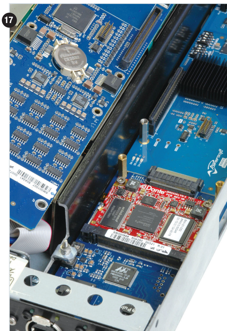
17 / La carte « petits signaux » reçoit le circuit Dante (en rouge), derrière lequel on découvre la carte DSP. Le circuit à gauche reçoit les composants d'entrée et les convertisseurs audio.
