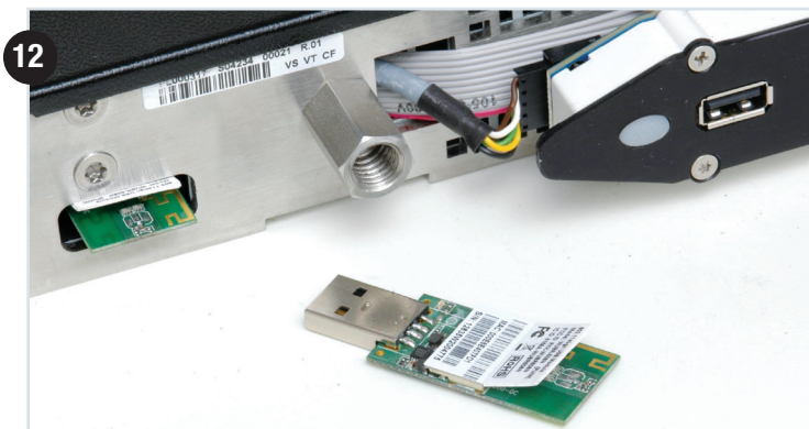
12 / L'interface Wi-Fi se fait par un module USB enfiché à gauche de la face, dans une zone d'où les ondes peuvent sortir. On voit au bout du module l'antenne imprimée sur le circuit. Au choix : 2,4 ou 5 GHz.
